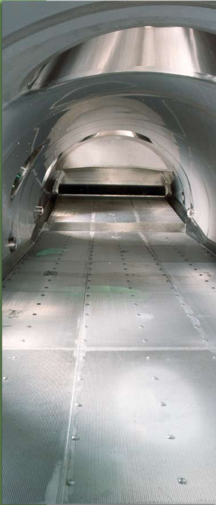
Газораспределительная решетка сушильной установки, из перфоллистов CONIDUR® CONIDUR® as distribution deck in a dryer
